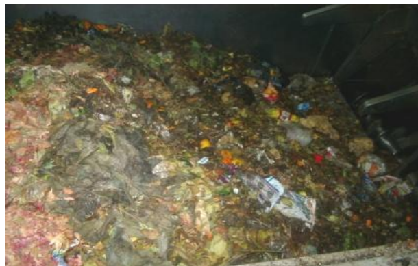
Küchenabfälle, überlagerte Lebensmittel und Gartenabfälle in einem Annahmehunker einer Biogas Anlage.
