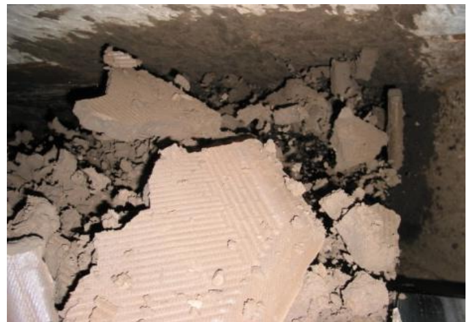
Mechanisch entwässertes Klärschlamm (38 % TS), aus einer Kammerfilter Presse
